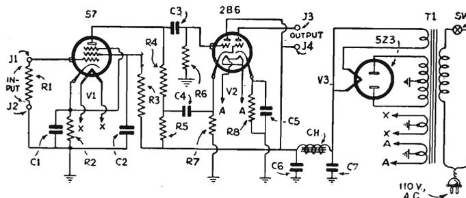
pacità di 25 mF. La tensione che è raccomandata per la 2B6 è di 250 volta. Però in questo apparecchio è stata impiegata una tensione di 290 volta e ciò dopo molte ricerche e prove, perchè è stato constatato che si poteva ottenere una maggiore potenza di uscita senza detrimento per la qualità di riproduzione. L'apparecchio qui descritto costituisce un amplificatore di grande potenza, di grande efficienza ed economico. Esso può essere usato tanto con un microfono che con un diaframma
